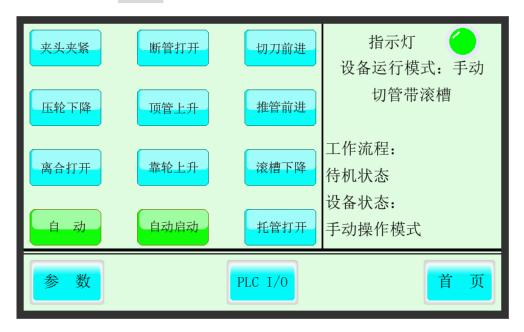
左上部方框内为设备手动操作按键,在手动运行模式下,按任一动作按钮,设备将进行相应的动作,其中自动按键为手/自动切换键,当按下时如下图所示:
